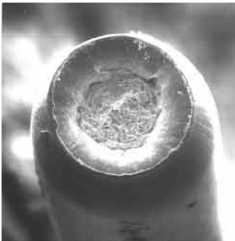
Frattura duttile piana
