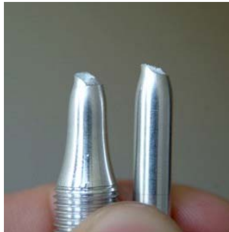
Frattura duttile a 45^\circ
