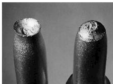
Rottura duttile a coppa-cono
